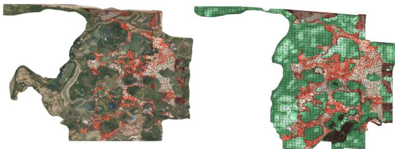
图 1-9 三维布尔运算方法计算挖、填方量
